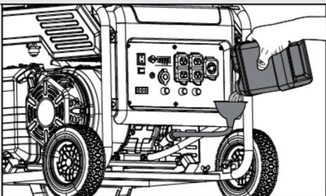
**3** 將發電機置於水平地面打開燃油箱頂部添加汽油。F為填滿，呈現E時必須再添加。添加完畢後蓋上汽油蓋。請勿添加過多汽油並將油箱蓋確實鎖緊周圍清理乾淨。
